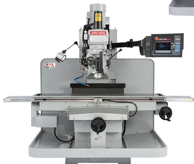
XYZ SMX5000 RUNKOTYYPPINEN JYRSINKONE PROTOTRAK-OHJAUKSELLA. LIIKKEET X/Y/Z 1524/596/540 MM, ISO40 KARTIO, KALLISTUVA JYRSINPÄÄ, PINOLIN SYÖTTÄ 140 MM.
