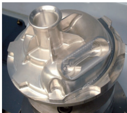
KUVAN TURBIININ KANSI ON KONEISTETTU MATSURIAN MAM 72-25V VIISIAKSELISELLÄ KONEISTUSKESKUKSELLE. OHJELMOINTI TEHTIIN GIBBSCAM OHJELMOINTIJÄRJESTELMÄLLÄ.
