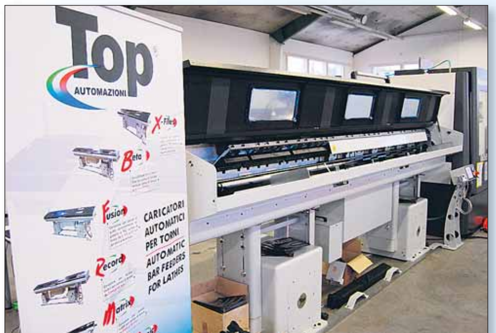
Lindbergin näyttelyssä NTJ-100 oli varustettu Top Automazionin automaattisella tangonsyöttölaitteella. Top Automazione on Lindbergin uusi edustus.
