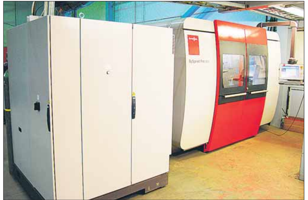
BySprint Pro kuuluu sveitsiläisvalmistajan Bystronicin keskeiseen hiilidioksidilaserleikkauskoneiden tarjontaan.
