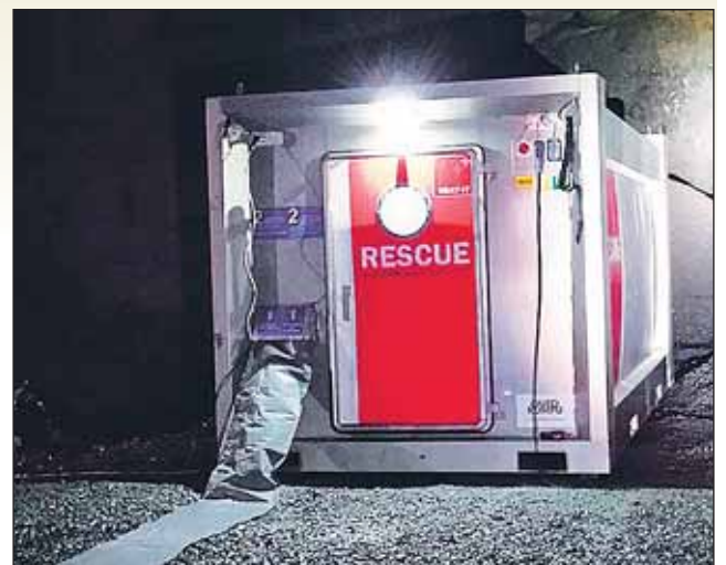
Heat-Itin kanssa toteutettu prototyyppi ruostumattomasta teräksestä valmistetusta suojakontista kaivoskäyttöön.
