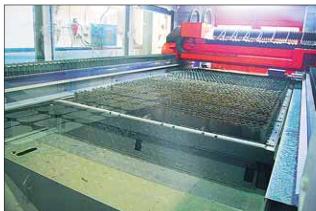
Kone on varustettu 3,3 kW:n laserilla. Työalue koneessa on 3048x1524 mm.
