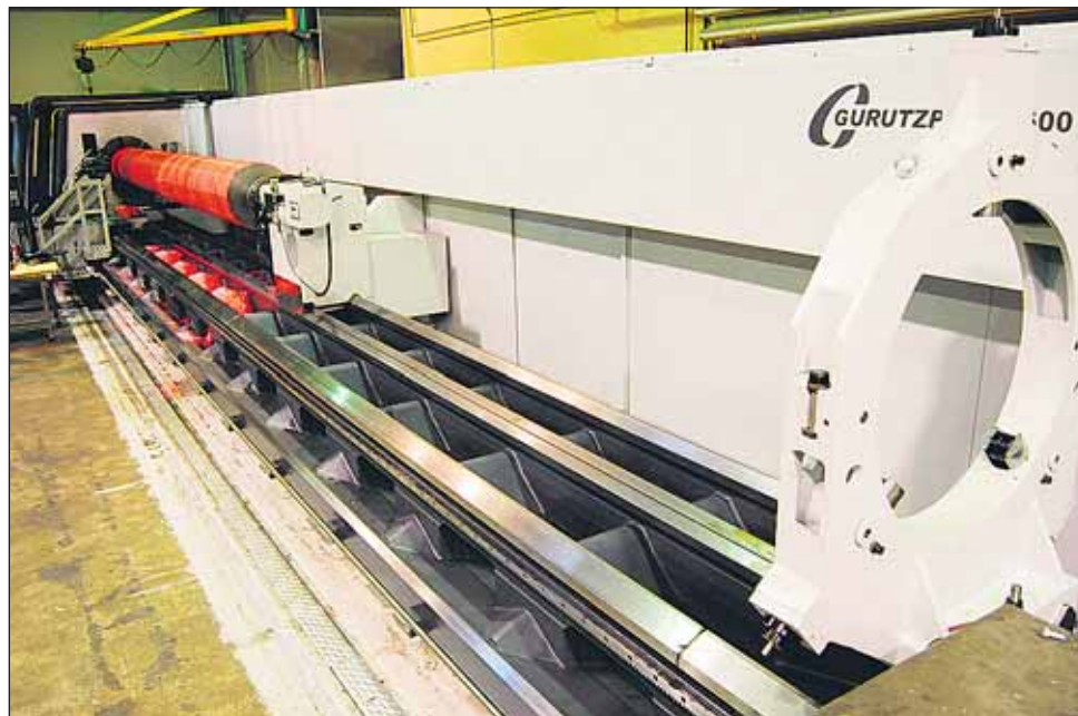
Sorvauspi-tuus Gurutzpen A-1600 4G-mallissa on 14 metriä, maksimi sorvaushalkaisija 1300 mm.
