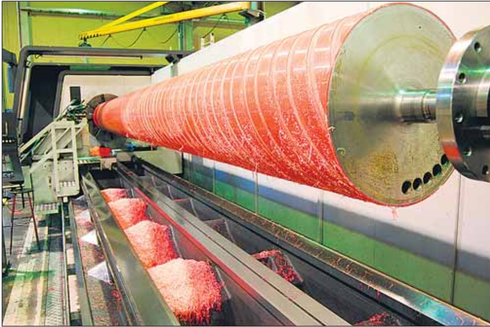
4-johderatkaisu tuo tukevuutta koneistukseen. Ratkaisu mahdollistaa sorvauskelkan ajon tukilaakerin ja kärkipylkän ohi.
