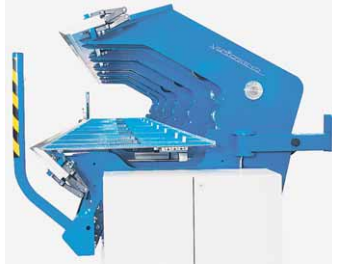
Suuri 770 mm. avauma sallii pienten kelojen purkamisen suoraan koneeseen. Myös profiilin kääntämiseen työpöydällä ei tarvita kuin yksi käyttäjä.
