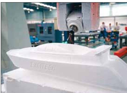
Eri käyttökohteita: ylhäältä vasemmalla autonosan trimmausta, komposiitin trimmausta, veneen malli, tuulimyllyn siipien tekoa, hyvin istuttava malli ja valumallin tekoa siivistä.
