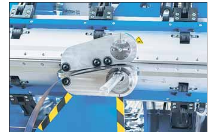
Leikkurin johdekiskot on kiinnitetty suoraan koneen runkoon, siten eivät taivutuspalkkien johdekiskot haittaa taivutustyötä, leikkurissa on myös välyksensäätö.
