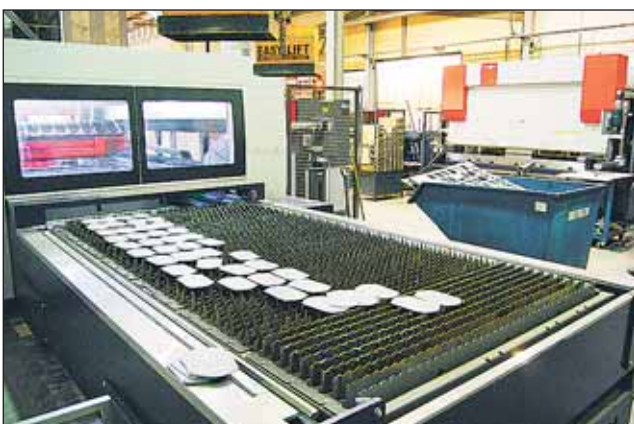
Uusi laser ja särmäyspuristin on sijoitettu Suomen Tekniikkapalvelun tiloissa lähelle toisiaan. PMC-järjestelmä mahdollistaa toimeksiantojen tuonnin laserille jatkossa automaattisesti.
