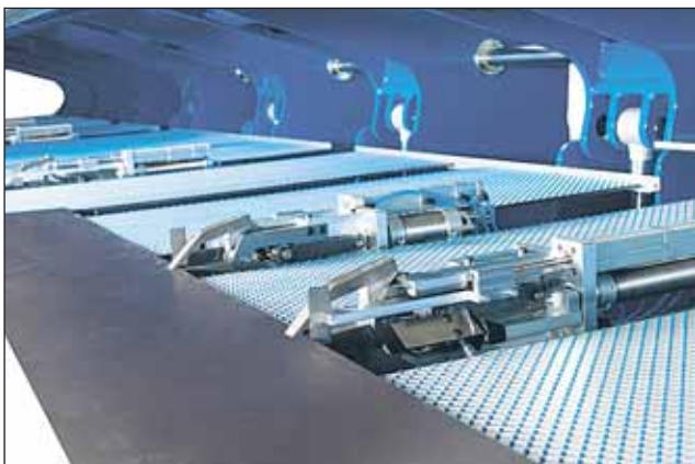
Sähkökäyttöinen kuulakarakavaste 5- 1250 mm. Kapeneva taivutus sekä profiilien kartiomainen sisäkkäinasetus kuuluvat perustointeihin. Kone voidaan myös varustaa automaattisilla tarttujilla. Harjapöytä estää materiaalin naarmuuntumisen.
