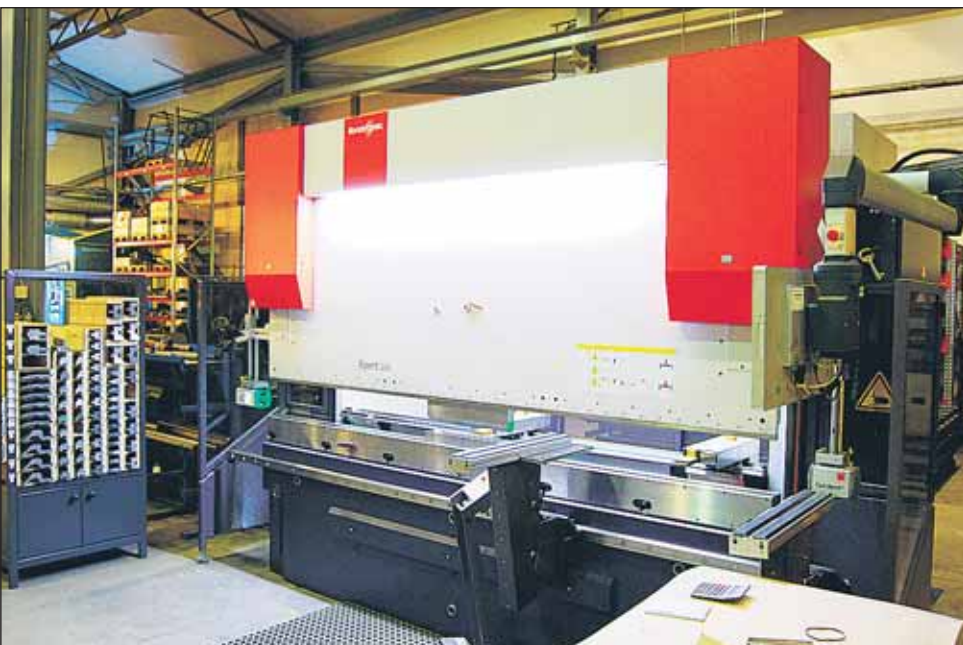
Xpert200-särmäyspuristinmallissa on max. taivutusleveys 3000 mm ja taivutusvoima 200 tonnia.
