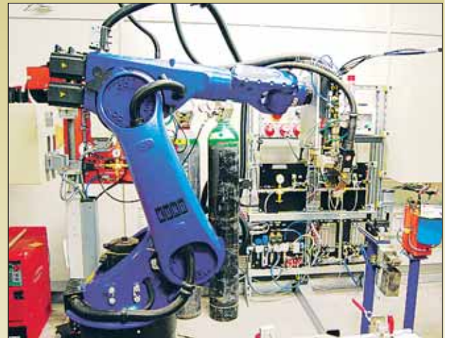
Kuvan JaloteräsStudion hydromuovauslaitteiston muovauspaine on max. 5000 bar. Vastaavia laitteita käyttää mm. autoteollisuus.
