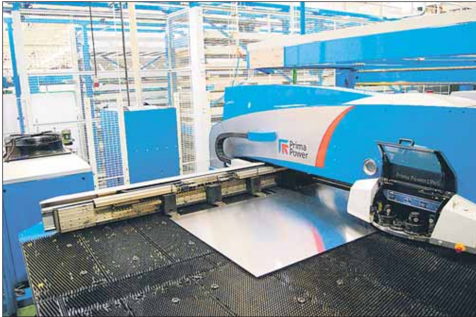
Tehokasta tuotantoa. 1,5x3 metrin levyille tarkoitetuilla kombikoneilla ajetaan lähinnä alumiinia.
