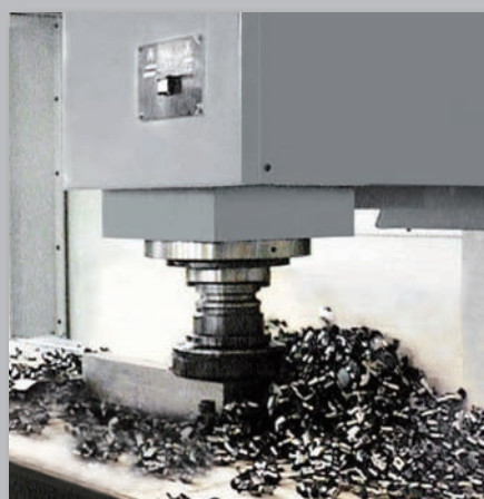
● 9mm Depth Face Milling (50#)
